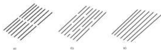
Рисунок 4 - Схемы некоторых типов разрушения полимеров: а) – разрушение химических связей; б) – разрушение скользящими молекулярной цепи; в) – разрушение водородной связи или силы Ван-дер-Ваальса
