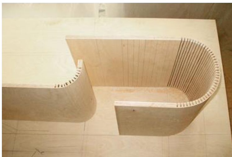
Рисунок 30. Изготовление изделия из гнутой фанеры
