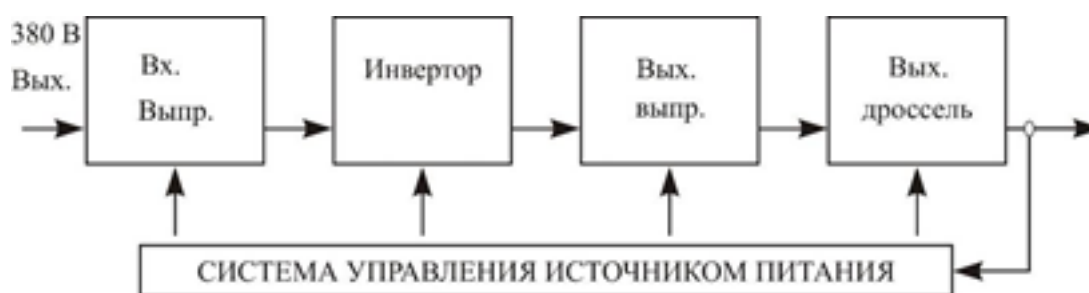
Рис. 2.2. Блок схема инверторного источника питания
