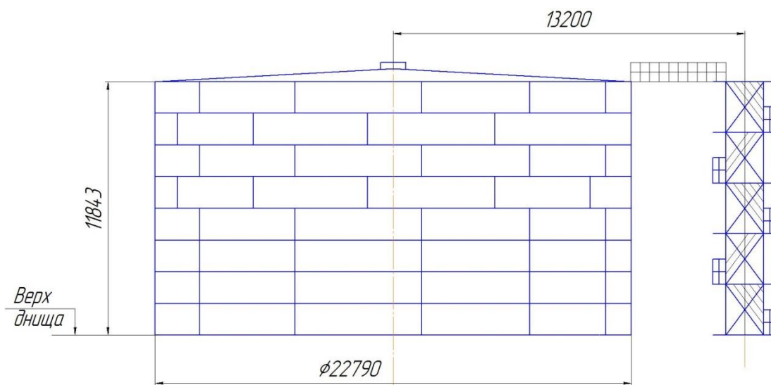
Рисунок 16 – Общий вид резервуара
