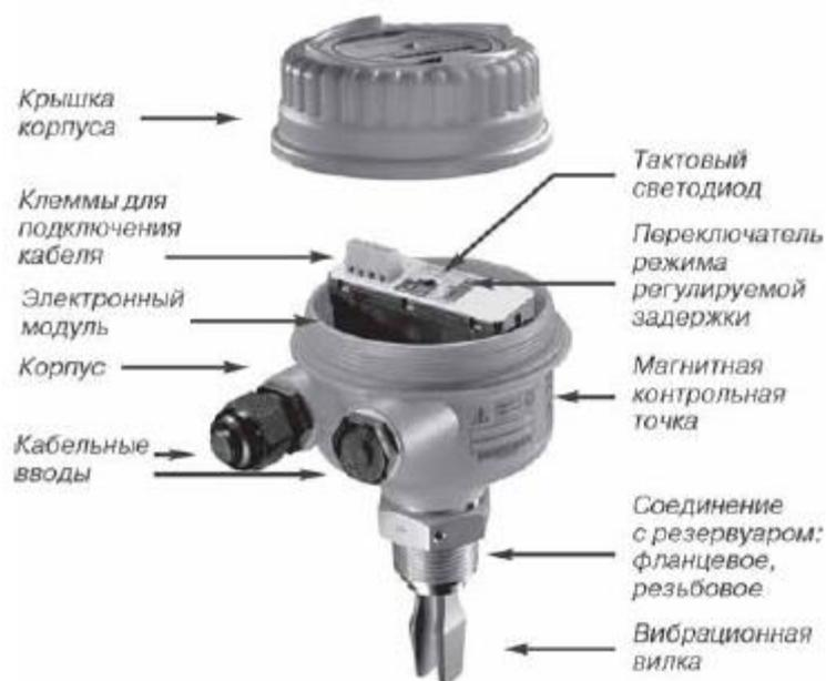
Рис. 4 Конструкция сигнализатора уровня Rosemount серии 2120
