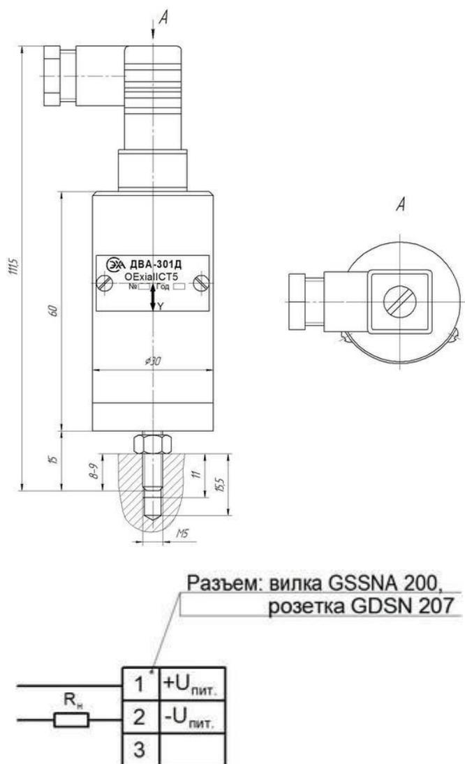
Рис. 8. Схема подключения
