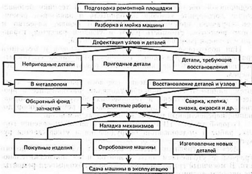
Рисунок 2. – Структура ремонтного процесса горного оборудования
