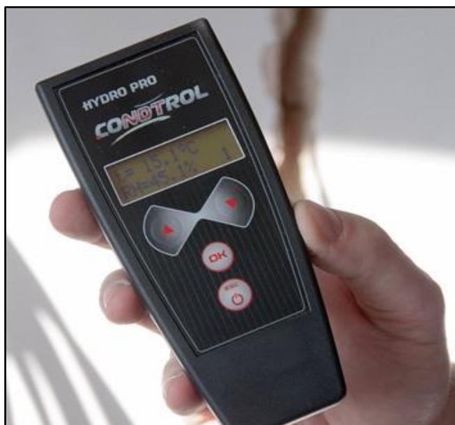
Рисунок 15 – Влагомер, работающий по принципу диэлькометрического метода 53
