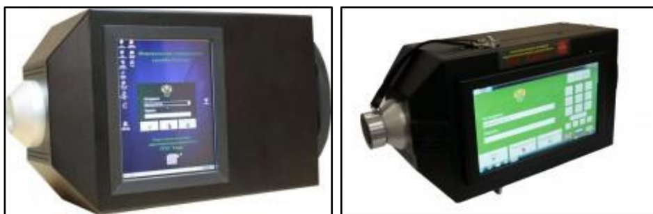
Рисунок 12 – Портативные приборы для идентификации пиломатериалов лиственных и хвойных пород древесины» 50
