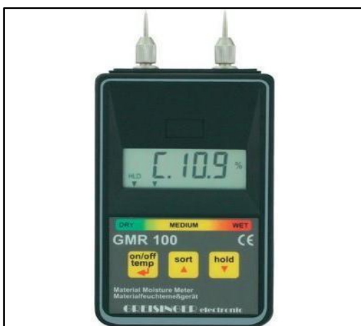
Рисунок 14 – Влагомер, работающий на принципе кондуктометрического метода 52
