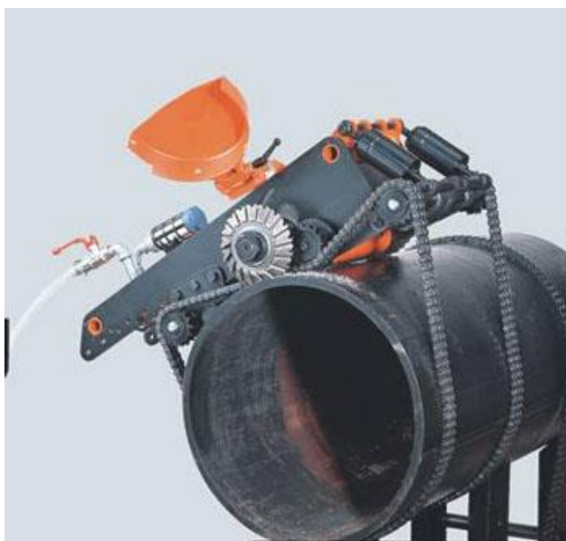
Рисунок 8 - Механизированная установка для холодной резки со снятием фаски RSG FEIN.
