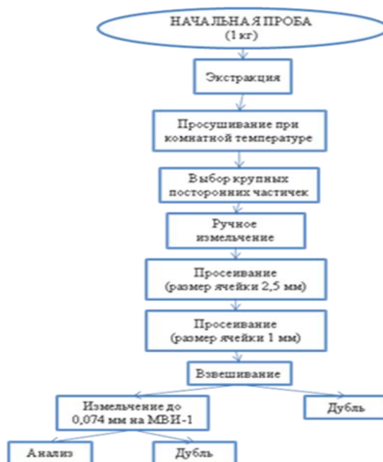
Рисунок 5 – Схема обработки изучения проб донных отложений [36].
