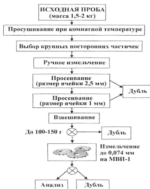
Рисунок 7 – Схема обработки и изучения проб почв [36].
