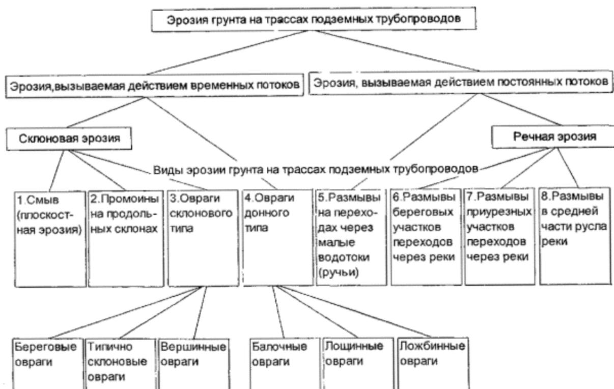
Рисунок 14 – Классификация видов эрозии грунта на трассах подземных трубопроводов
