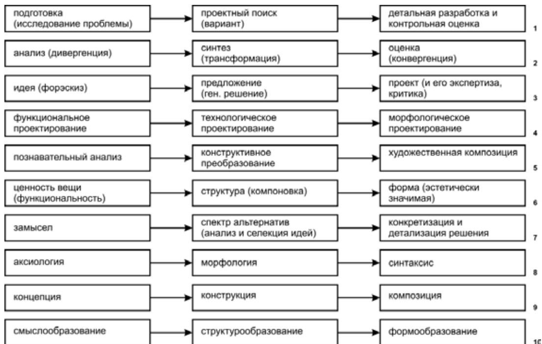
Рисунок 1.3 Цепочки процедур проектирования и определения категорий объекта на основе принципа мышления «анализ-синтез-оценка»
