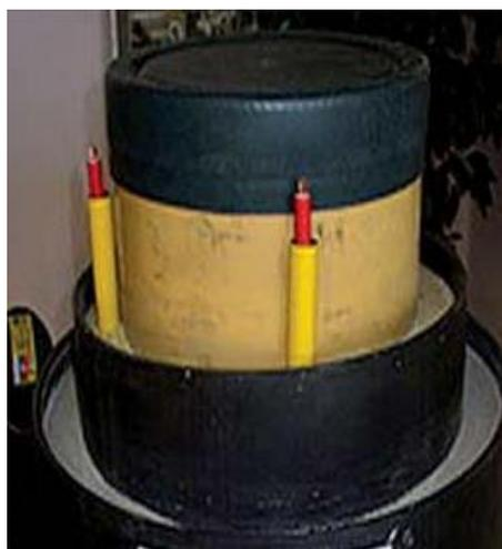
**Рис. 1.17.** Трубопроводы с балластным покрытием в металлополимерной оболочке: 1 - труба с наружным трёхслойным полипропиленовым и балластным покрытиями; 2 - труба с наружным эпоксидными и балластными покрытиями; 3 - труба с наружным эпоксидным, тепловым полиуретановым и балластными покрытиями с установленной системой подогрева труба основе «Скин-Эффекта».
