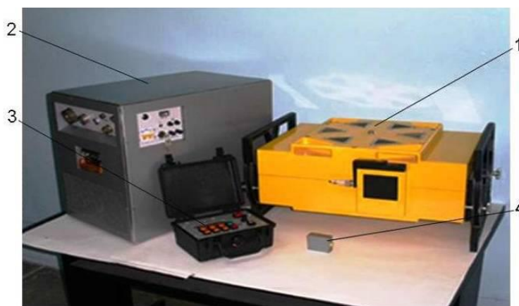
Рис.6 Малогабаритный бетатрон типа МИБ-7.5 (1 – излучатель; 2 – блок питания; 3 – пульт управления; 4 – выносной дозиметр).
