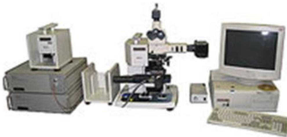
Рисунок 2.8 - Нанотвердомер Nano hardness tester NHT-S-AX-000X.
