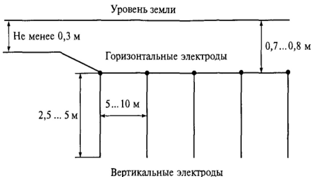
Рисунок 6.2 Схема линейного комбинированного заземления
