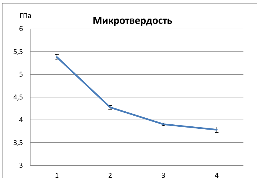
Рис. 20. Микротвердость сплава ВТ6: 1 – образец сплава МЗ в исходном состоянии, 2 – образец сплава МЗ после отжига при 750 °С, 3 – образец сплава МЗ после отжига и наводороживания до 0,05 мас.%, 4 – образец сплава МЗ после облучения и наводороживания до 0,05 мас.%
