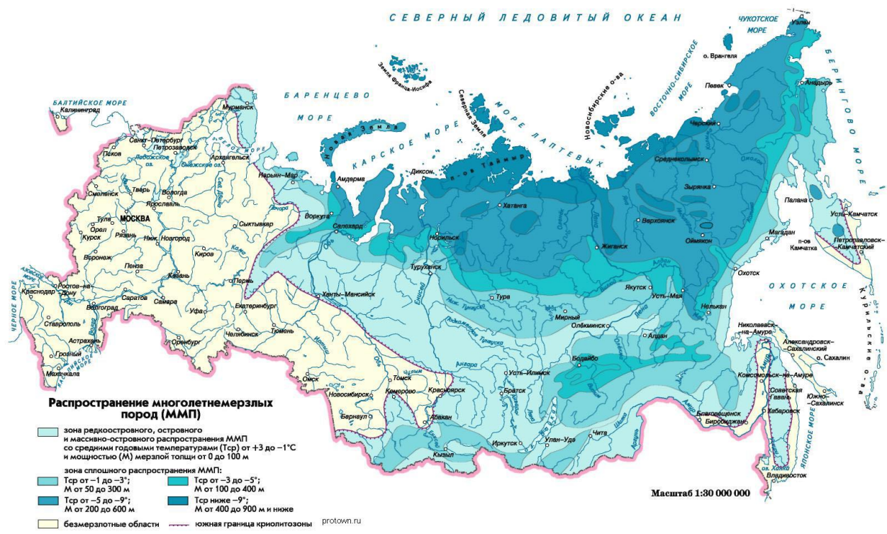
Рисунок - 4 Схема распространения многолетнемерзлых грунтов в России
