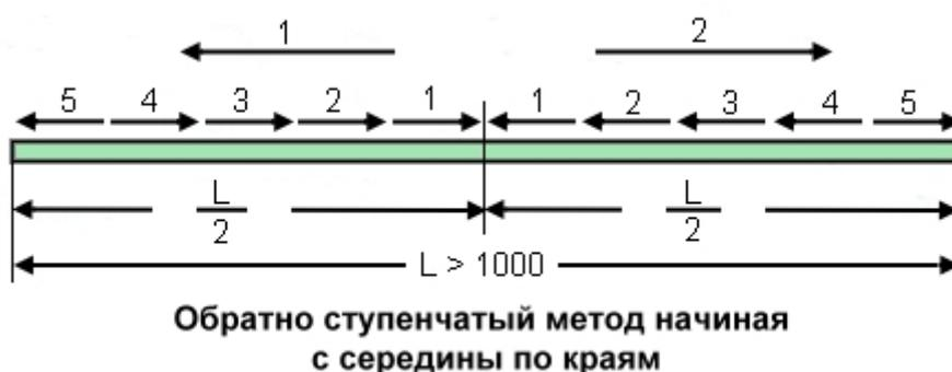
Рисунок 8 – Обратноступенчатый способ сварки
