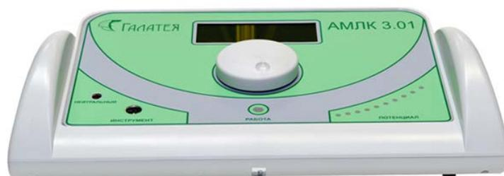
Ультразвуковой режим работы: частота колебаний излучателя 28, 880, 2640кГц.
