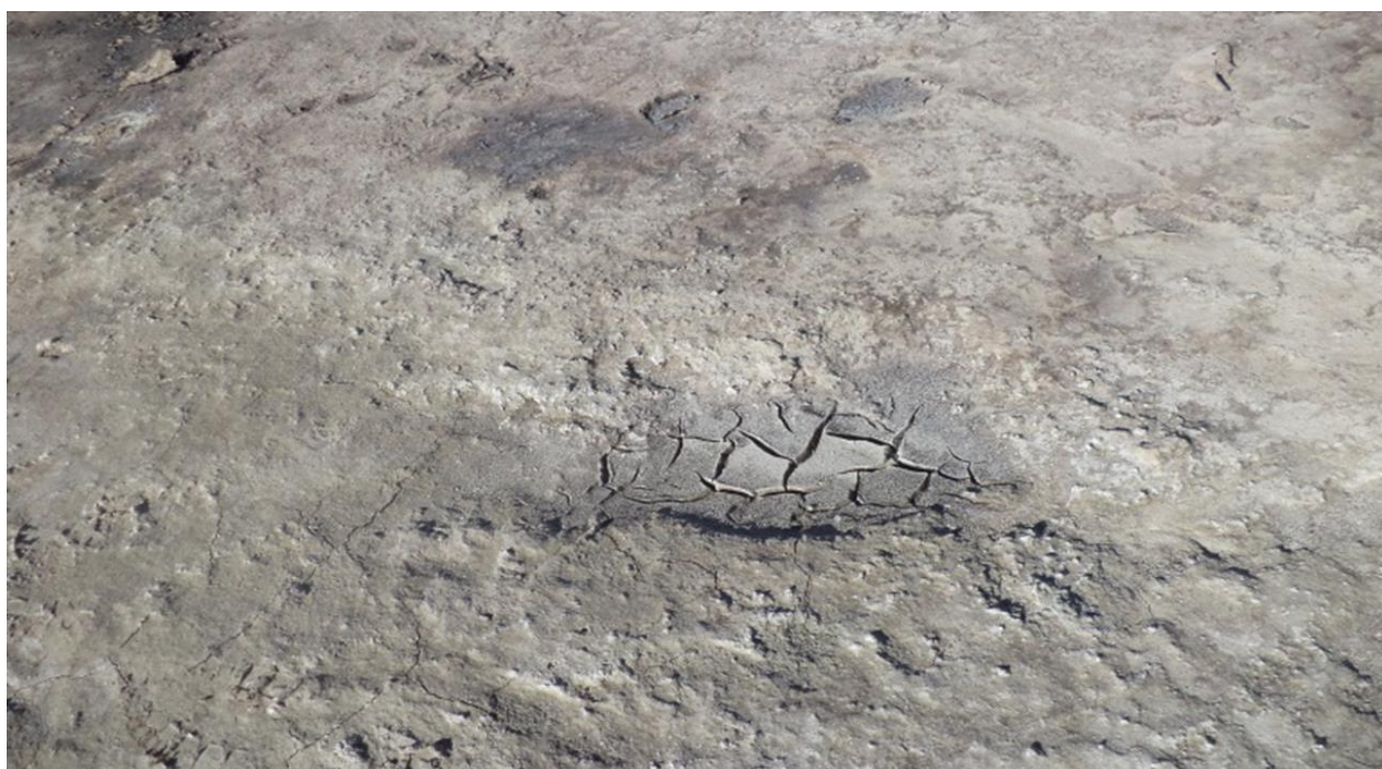
Рисунок 4.23 По результатам испытаний, полимерные соединения хорошо прикрепляются в момент их вбрызгивания, но после месяца от начала эксперимента образуются трещины и из под покрова поднимается пыль.
