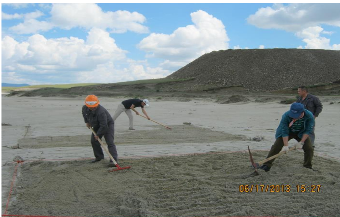
Компания “Эм Ай Эйч” разбрызгивали полимерный раствор 100 м 2 опытного участка) Рисунок4.19[38]
