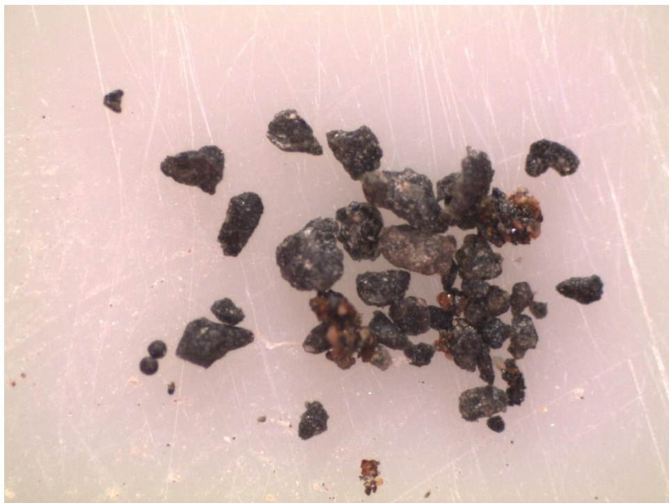
Рисунок 4.14. Частицы магнетита, гематита и железа под бинокулярным микроскопом увел. 35 x
