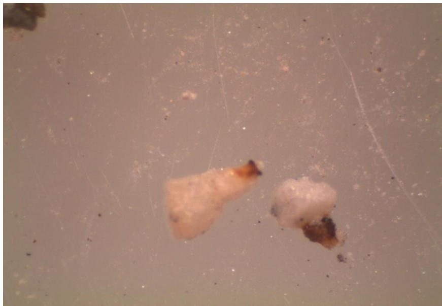
Рисунок.4 11. Частица альбита под бинокулярным микроскопом увел. 35 x
