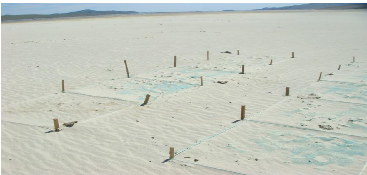
Рисунок 4.24 Хорошие результаты зафиксированы при покрытии песчаного пляжа хвостохранилища синтетической сеткой.
