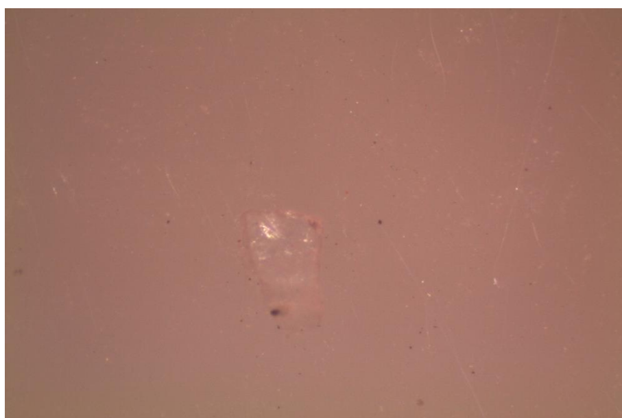
Рисунок4.12. Частица кварц под бинокулярным микроскопом увел. 35 x
