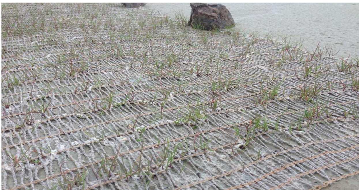
(Компания “Нумт бар” накрыли специальным траворастирующим покрытием участок 2м 2 ) Рисунок4.20[38]
