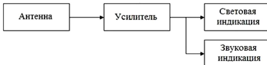
Рис. 1. 5. Структурная схема искателя на логических элементах.
