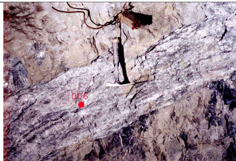
Рис. 4.10 Кварцевые прожилки СЗ простирания, смещенные поздними нарушениями (кровля разв. штрека 16с, гор. 17, Быструшинская залежь)
