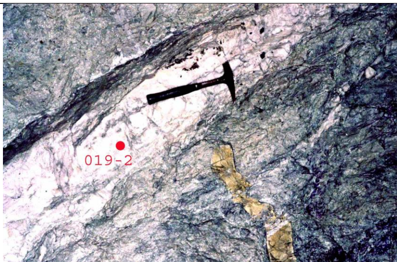
Рис. 4.5 Кварцевая жила с вкрапленностью сульфидов выполняет зону дробления, апофиза дайки диабазов (буро- желтого цвета) (западная стенка орта 27, гор. 16 Южный фланг Быструшинской залежи)
