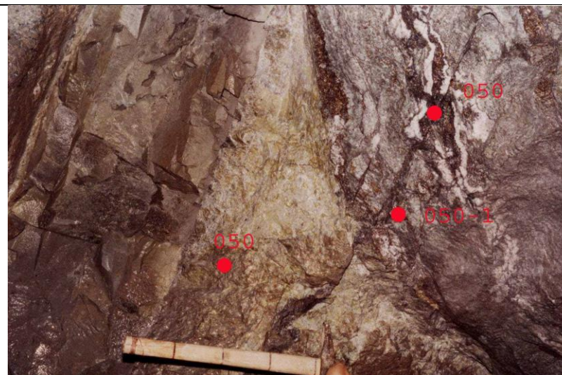
Рис. 4.20 Дайка диабазовых порфиров (слева), сульфидная жила (справа), серицит-хлорит-кварцевой вмещающей породе (в центре) (залежь Победа, гор. 15, разв. штрек 1в/1)
