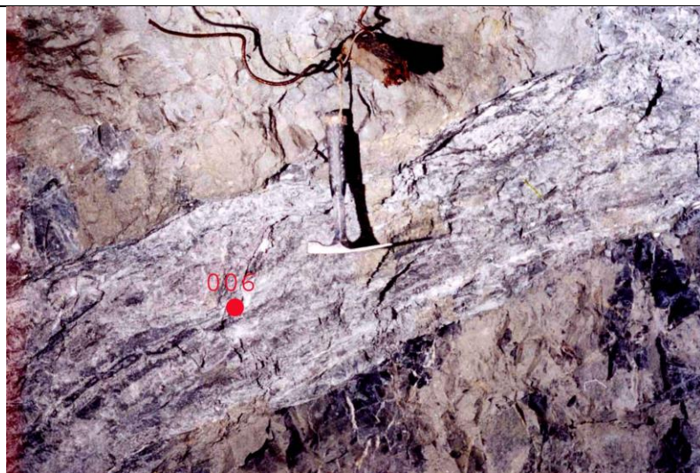
Рис. 4.7 Свинцово-цинковое оруденение в зоне дробления (разведочный штрек 27, орта 15, Южный фланг Быструшинской залежи)
