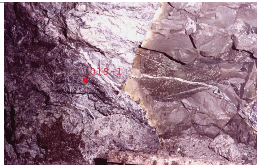
Рис. 4.4 Взаимоотношения дайки диабазов с поздними кварц-карбонатными прожилками (восточная стенка орта 27 Ю гор. 16 Южный фланг Быструшинской залежи)
