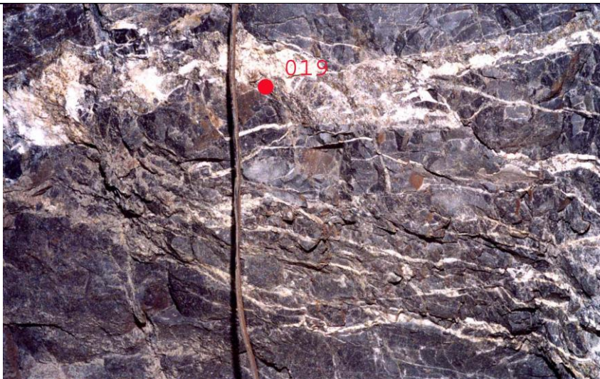
Рис. 4.1 Сеть кварцевых прожилков в микрокварцитах (развед. штрек 27, гор. 15 Южный фланг Быструшинской залежи)
