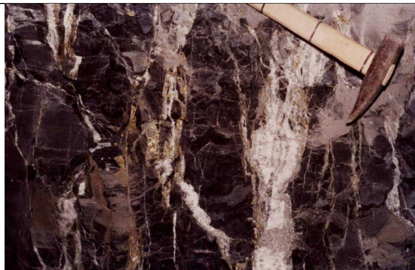
Рис. 4.18 Вертикальные карбонат-кварц-сульфидные прожилки в микрокварцитах (3-я ЮЗ залежь, гор. 16, скр. штр.)
