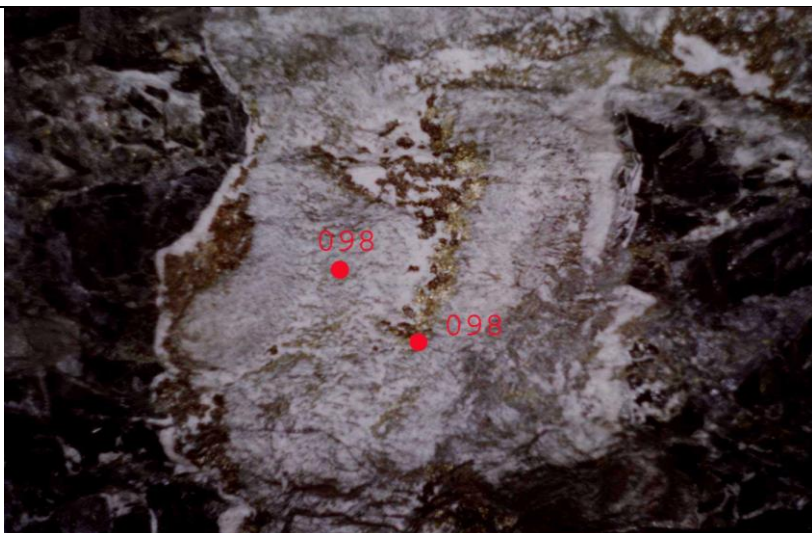
Рис. 4.15 Золото-кварц-сульфидная жила мощностью до 1,5 м в центральной части зоны дробления (кровля выработки) (3-я ЮЗ залежь, гор. 16, р.ш. 25-II/2)
