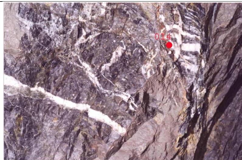
Рис. 4.2. Система разно ориентировочных кварцевых прожилков с сульфидной минерализацией в микрокварцитах (кровля орта 27, гор. 15 Южного фланга Быструшинской залежи)
