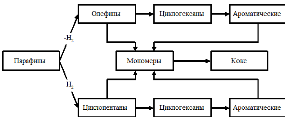
Рисунок 2.1. Реакции уплотнения на Pt-катализаторах риформинга бензинов
