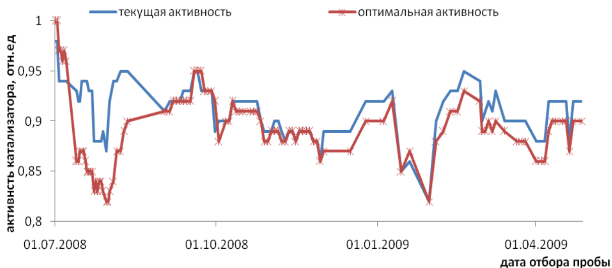
Рис. 3.2 Соотношение текущей и оптимальной активности катализатора установки ЛЧ-35-11/1000 в 7 сырьевом цикле (расчет на модели)
