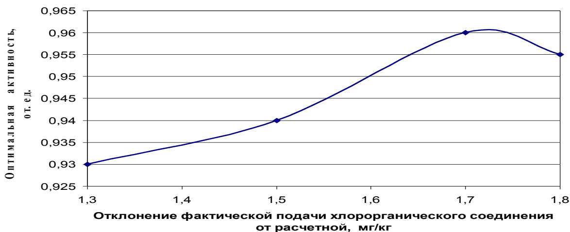
Рисунок 3.7 Влияние содержания хлорорганических соединений на активность катализатора в присутствие сероводорода
