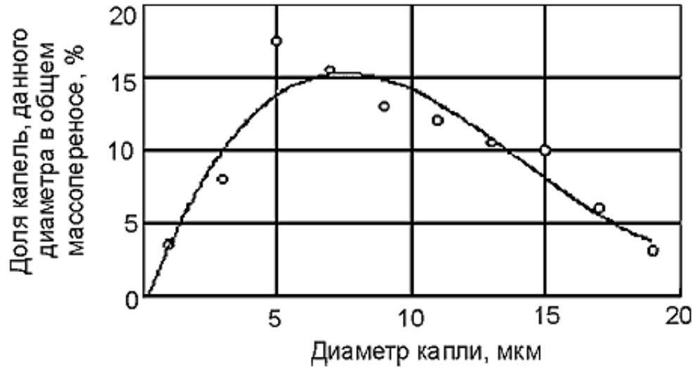
Рисунок 1.5. Доля капель данного диаметра в общем массопереносе для дуги с титановым катодом [49]
