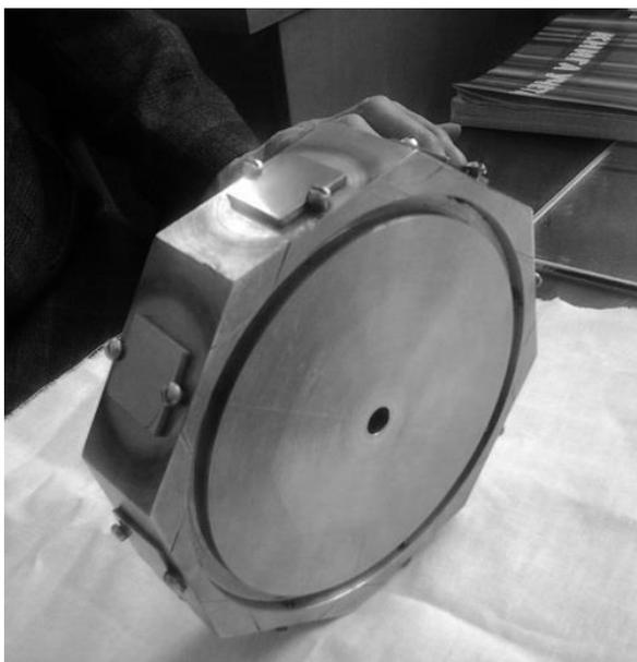
Рисунок 2.3. Внешний вид держателя образцов
