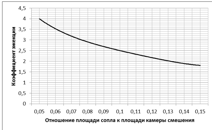
Рис. 57. Зависимость коэффициента эжекции от отношения площади сопла к площади камеры смешения [113]
