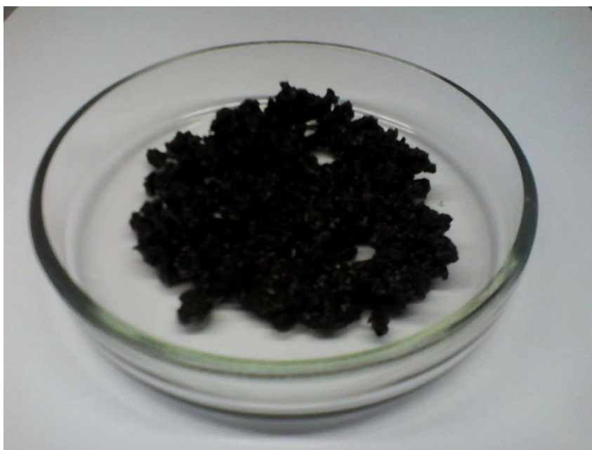
Рисунок 3.7. Внешний вид продуктов взаимодействия жидкого стекла и портландцемента марки ЦЕМ-I-42,5Б
