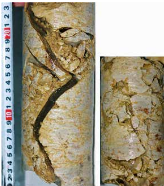
Рис.4.3. Трещинные, трещинно-жильные криотекстуры нижнесилурийских известняков (глубина 103 м).
