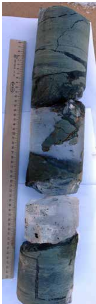
Рис. 4.5. Трещинно-жильная криотекстура юрских песчаников с прослоем льда толщиной 10 см (глубина 5 м).
