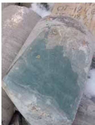
Рис. 4.4. Трещинные криотекстуры ордовикских известняков (глубина 185 м).
