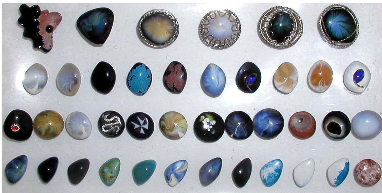
Рис. 2 Пуговицы, изготовленные по технологии вытягивания из расплава с последующим декорированием
