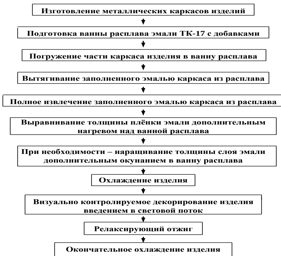
Рис. 4.6 Технологическая схема светолучевого изготовления изделий в технике «витражная эмаль» методом вытягивания изделия из расплава с последующим декорированием охлаждённого расплава в световом потоке
