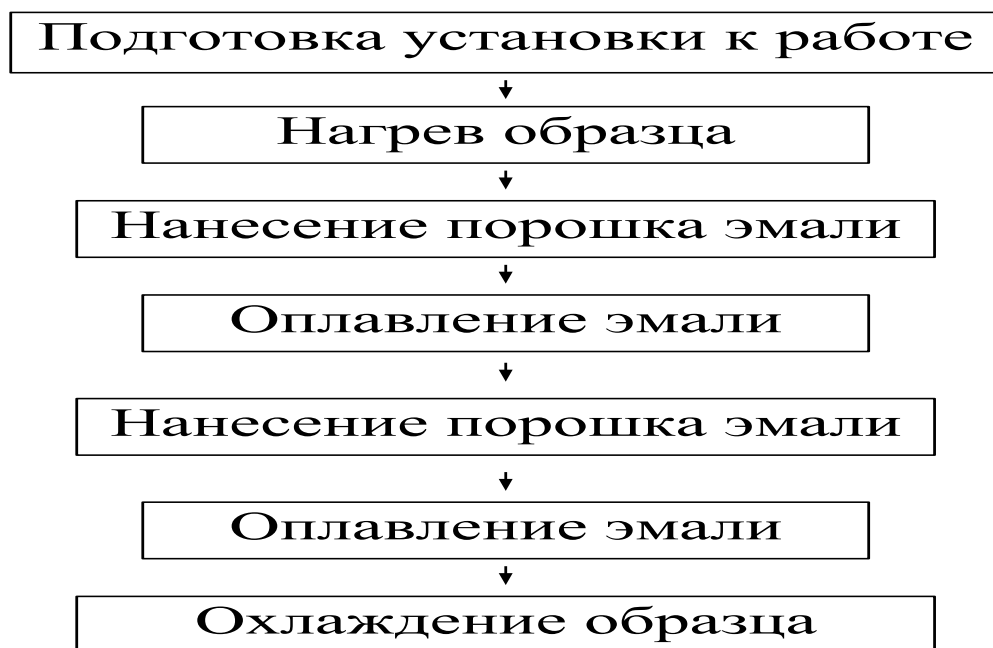
Рис. 4.5 Технологическая схема светолучевого экспресс-эмалирования стальных образцов
