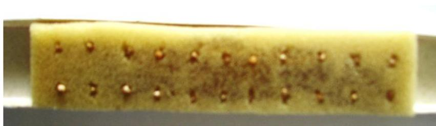
Рисунок 3.4 – Размещение зерен на специальной ячеистой поролоновой форме
