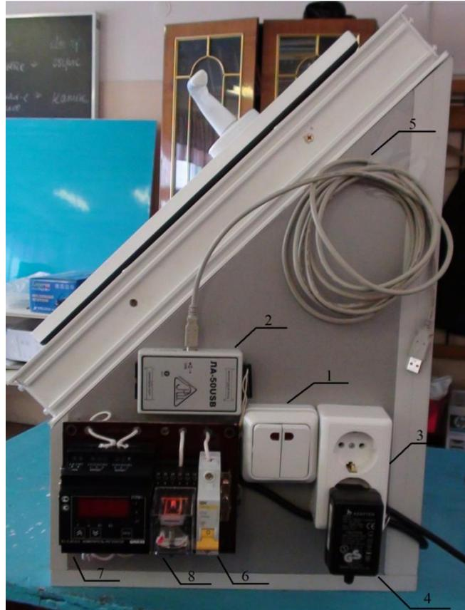
1 - двухкнопочный выключатель; 2 - плата сбора данных «ЛА–50USB; 3 – розетка; 4 - блок питания; 5 - кабель USB; 6 - автомат S231R C10; 7 - ОВЕН 2ТРМ1; 8 - реле 600DSKY RK307 ALT установленное на релейную базу PF 113В-Е
