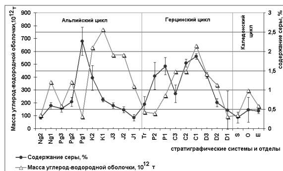
Рис. 3. Изменение содержания серы в нефтях и массы углерод-водородной оболочки по стратиграфическим комплексам
