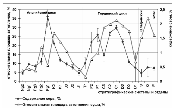
Рис. 2. Изменение содержания серы в нефтях и относительной площади затопления по стратиграфическим комплексам
