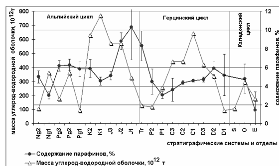
Рис. 5. Изменение содержания парафинов в нефтях и массы углерод-водородной оболочки по стратиграфическим комплексам
