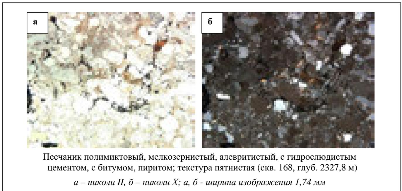
В небольших количествах присутствует гелефицированный и фюзенизированный растительный детрит. Часто встречаются и эпигенетические изменения структурного порядка – коррозия и растворение контуров зерен, слабые явления припая, вдавливания, приспособления и регенерации зерен, деформация слюд и обломков пород.
