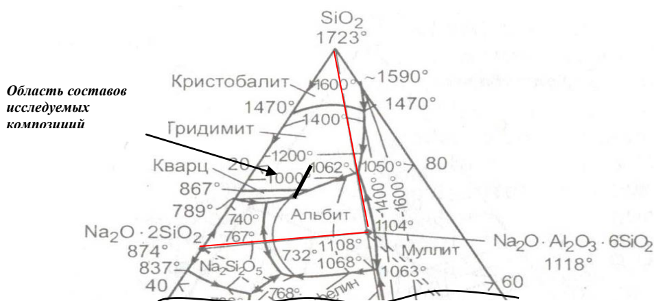
Рисунок 3.18 – Расположение исследуемых составов стекла в диаграмме состояния \text{Na}_2\text{O}-\text{Al}_2\text{O}_3-\text{SiO}_2
