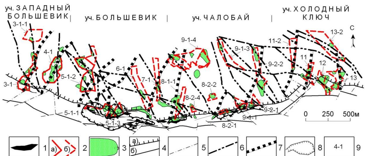
Рисунок 4.3. Расположение участков с максимальными мощностями разведанных рудных тел в проекции на горизонтальную плоскость:
