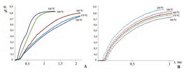
**Рис. 1.** Зависимость степени испарения воды из ГДТ от времени при различной температуре: A – без добавления рутилизирующей добавки; B – c добавлением рутилизирующей добавки
