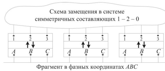
Рис. 3. Подключение трёхфазного фрагмента к схеме в системе симметричных составляющих
