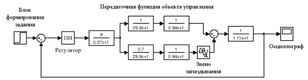
Рис. 1. Модель САР температуры углеводородного конденсата на выходе из кожухотрубного теплообменника
