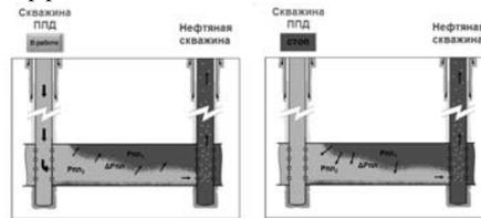
Рис. 3 Возникновение перепадов давления внутри пласта [3]
