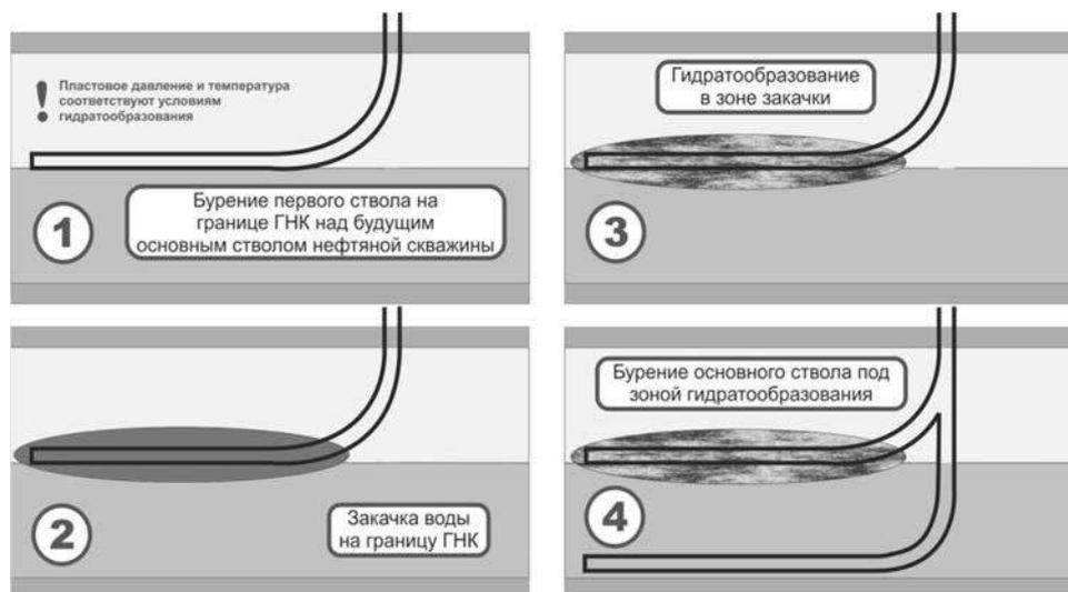
Рис. Поэтапный процесс гидратообразования
