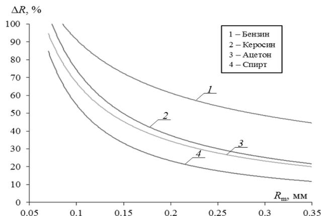
Рис.3 Зависимость параметра  $\Delta R$  от начального размера  $R_m$  капль распыленной воды при прохождении продуктов сгорания типичных нефтепродуктов при  $U_m \approx 2$  м/с,  $T_m = 293$  К
