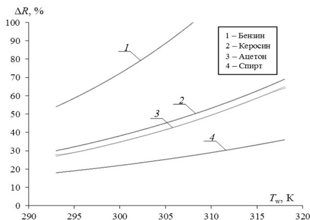
Рис.2 Зависимость параметра  $\Delta R$  от начальной температуры  $T_w$  капль распыленной воды при прохождении продуктов сгорания типичных нефтепродуктов при  $U_m \approx 2$  м/с,  $R_m = 0,25$  мм
