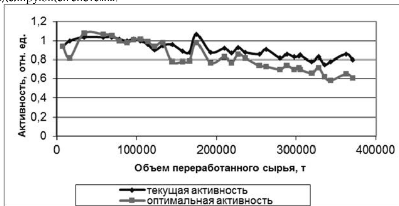
Рис. 1. Мониторинг работы промышленной установки каталитического риформинга бензинов
