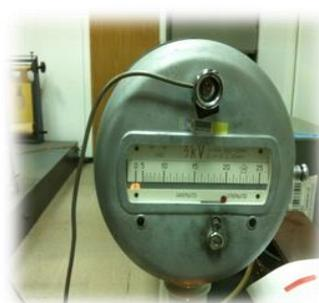
Далее натерли поочередно оргстекло и полиэтиленовый пакет шерстяной тканью, затем прикоснулись к корпусу статического киловольтметра и зафиксировали электростатическое напряжение.
