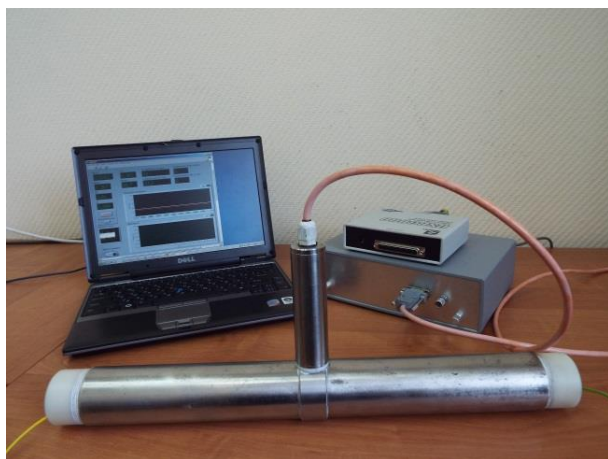
Рисунок 7 – Внешний вид макета измерителя емкости CAP-10 и его лицевая панель
