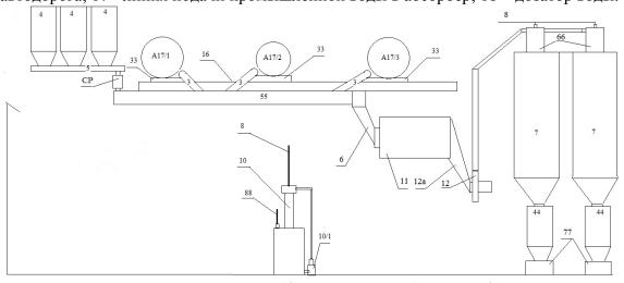
Рис. 2. Технологическая схема (фас, вид спереди) и спецификация отделения отгрузки нейтрализованного фторангидрита: 33 — шибер запорный; 3 — транспортный шнек; 4 — контейнер транспортный для гидроксида кальция; 44 — контейнер транспортный для фторангидрита нейтрализованного; 5 — шнек-дозатор;
