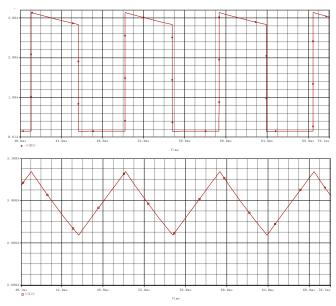
Рис. 4. Диаграммы тока на резисторе R1, дросселе L. Параметры элементов: L=150 mH; R1=7 OM; R2=1OM; R3=50OM; R4=2кOM; R5=500OM; R6=1кOM; V1=14B; V2=15B; V3=2.9B
