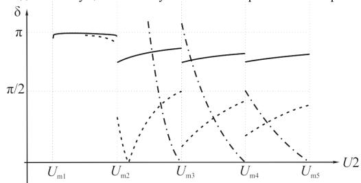
Рис. 2. Зависимость погрешности измерения в зависимости от пороговых напряжений компараторов.
