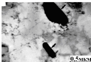
Рис. 2. Электронно-микроскопическое изображение тонкой структуры стали 08X18H10T (основной материал) вдали от заклепки. Стрелками отмечены частицы карбидов TiC
