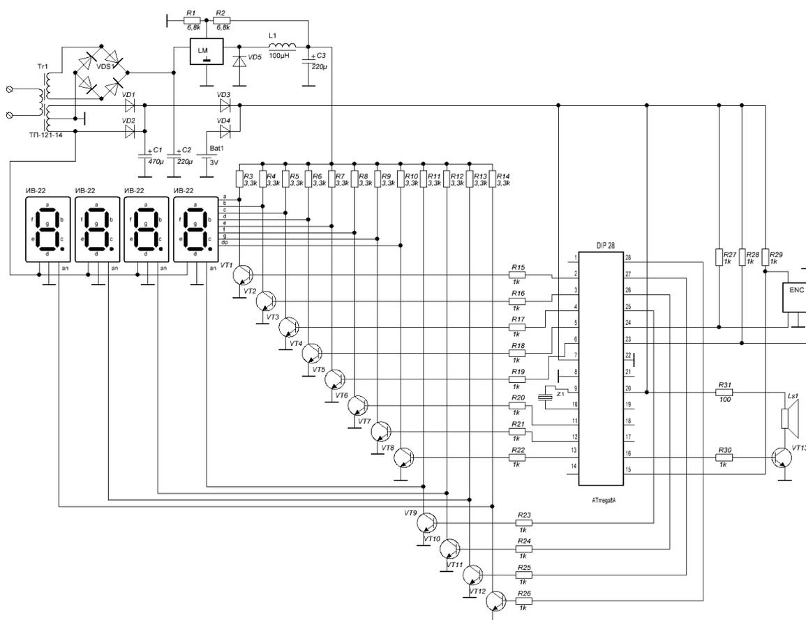
Рис. 2. Принципиальная схема часов
