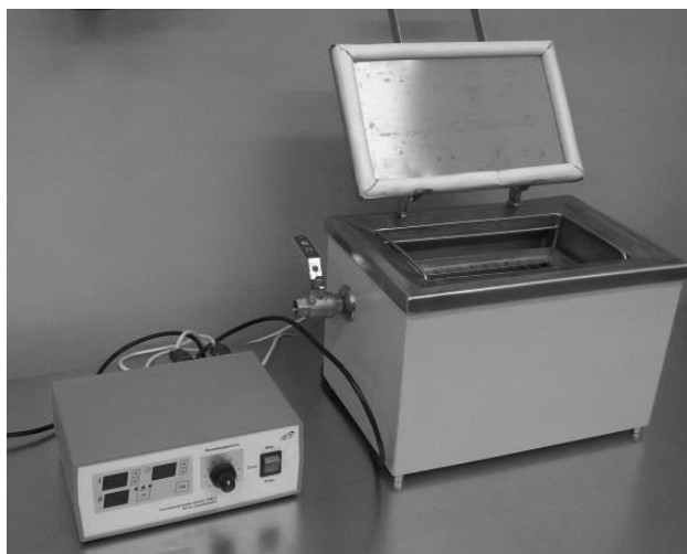
Рис. 4. Внешний вид ультразвуковой ванны и блока управления
