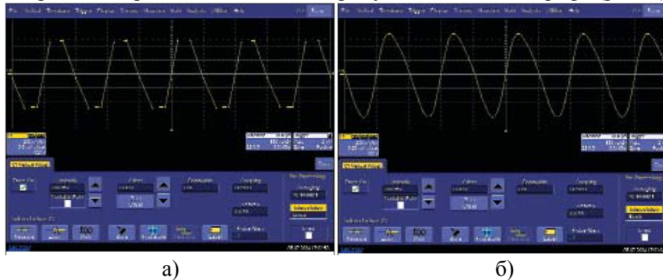
Рис. 2. а) – интерполяция линейная, частота дискретизации – 5 МГц, входной сигнал – меандр с частотой 1 МГц; б) – интерполяция \sin x/x , частота дискретизации – 5 МГц, входной сигнал – меандр с частотой 1 МГц
