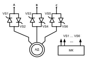
Рис. 1. Устройство ТРН-АД
