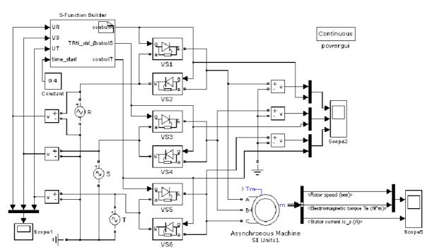
Рис. 4. Схема системы ТРН-АД в программе Matlab Simulink
