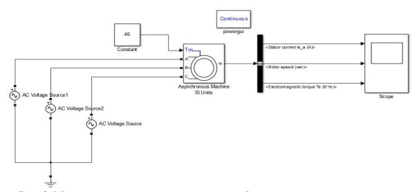
Рис. 2. Модель устройства плавного пуска трехфазного асинхронного двигателя
