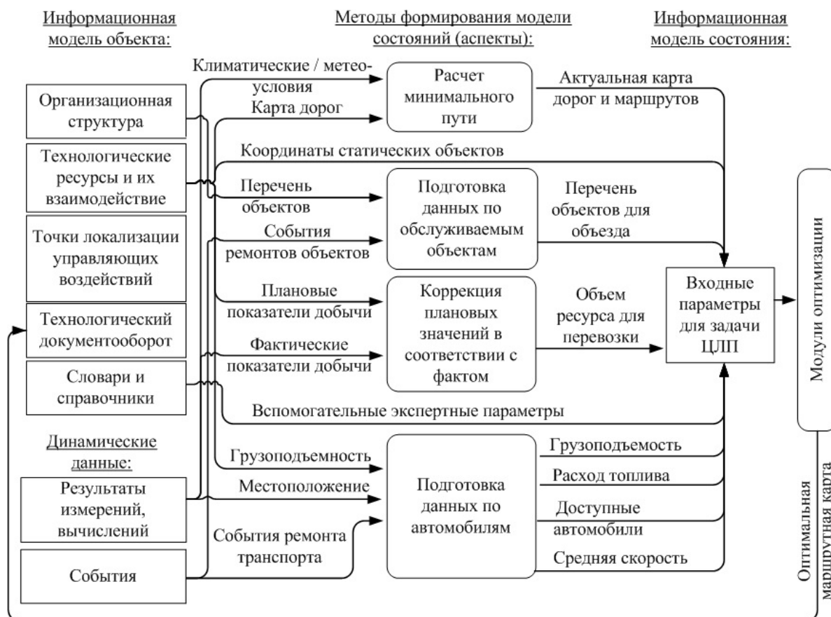
Рис. 2. Динамическая информационная модель системы для определения оптимальной маршрутной карты в виде диаграммы потоков данных. Эволюция данных от источников «сырых» данных к входным параметрам задачи ЦЛП с указанием необходимых шагов преобразований
