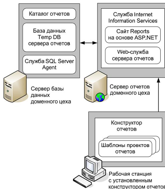
Рис. 1. Архитектура системы разработки, распространения и хранения отчетов
